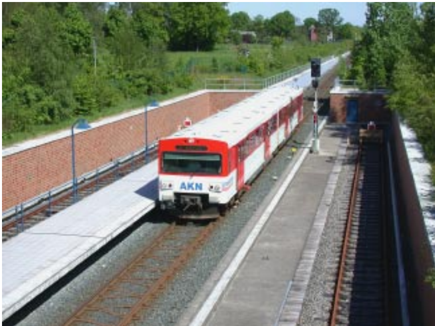
Einfahrt der AKN in den Bahnhof Norderstedt Mitte, wo am gleichen Bahnsteig Anschluß an die U 1 besteht. Der abgebildete Triebwagen ist eines der Fahrzeuge, die für die Möglichkeit eines Stromschienenbetriebes auf der S-Bahn umgebaut wurden - zu erkennen an den roten Kästen an den äußeren Drehgestellen, in denen sich die Stromabnehmer verbergen.
