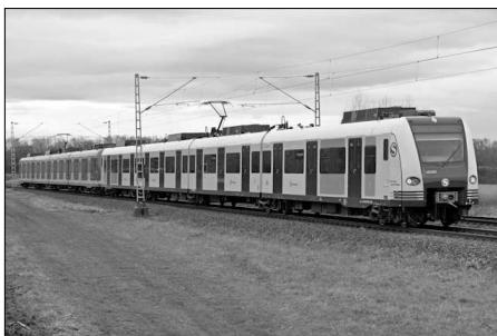
S-Bahn-Fahrzeuge sind zudem in Ballungsräumen für eine hohes Fahrgastaufkommen bei kurzen Haltestellenabständen und häufigem Fahrgastwechsel konzipiert. Dies bedeutet bei der Einfahrt eines Zuges, dass man ihn – insbesondere bei Mischbetrieb – sofort als S-Bahn-Zug erkennen sollte. Darüber hinaus sollte für den Fahrgast deutlich erkennbar sein, wo die Türen und die einzelnen Bereiche sind, auf die beim Einsteigen zu achten ist. Dies sind in erster Linie die 1.-Klasse-Abteile sowie be-
